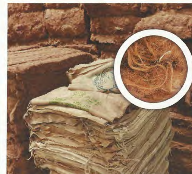
Aus alten Jutesäcken wird Dämmstoff. Mit pflanzlichem Bindegewebe kann er kompostiert werden.
